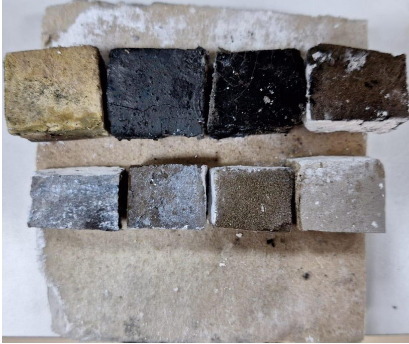
Görsel 2.3 Dinamik sürtünme katsayısı ölçümü için kullanılan numuneler a)Zirkonyum Kaplama b)Bor Karbür (1-3 Mikron) Kaplama c)Zirkonyum Karbür Kaplama d)Titanyum Nitrür Kaplama e)Zirkonyum Silikat f)Titanyum Karbür Kaplama g)Tantalyum Kaplama
